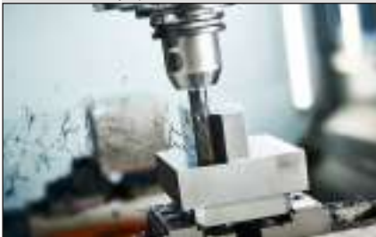
Fresado de apoyos laterales
