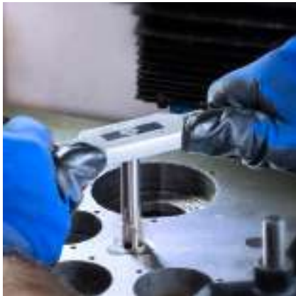
5º operación Rotura de la muesca de arrastre con una herramienta de corte específica
