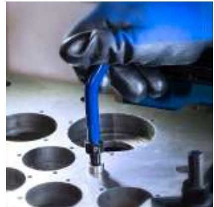
4º operación Atornillar el inserto Coil con la herramienta correspondiente
