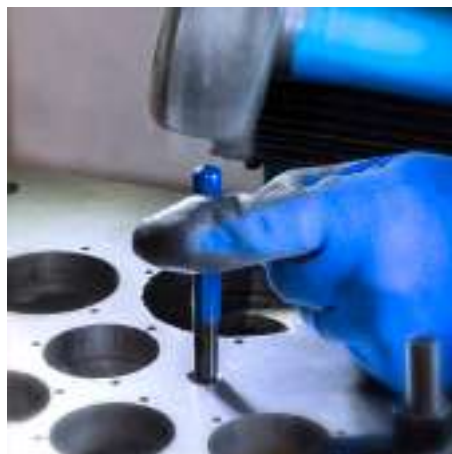
5º operación Rotura de la muesca de arrastre con una herramienta de corte específica
