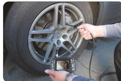
Ejemplo: Inspección pastillas de frenos
